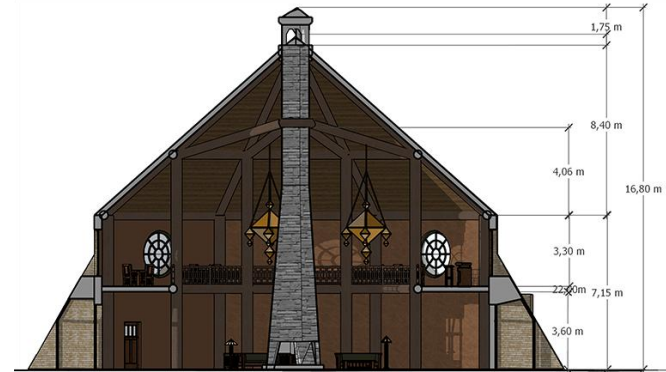
ПОПЕРЕЧНИЙ РОЗРІЗ ЦЕНТРАЛЬНОГО ЛОБИ М1:200
