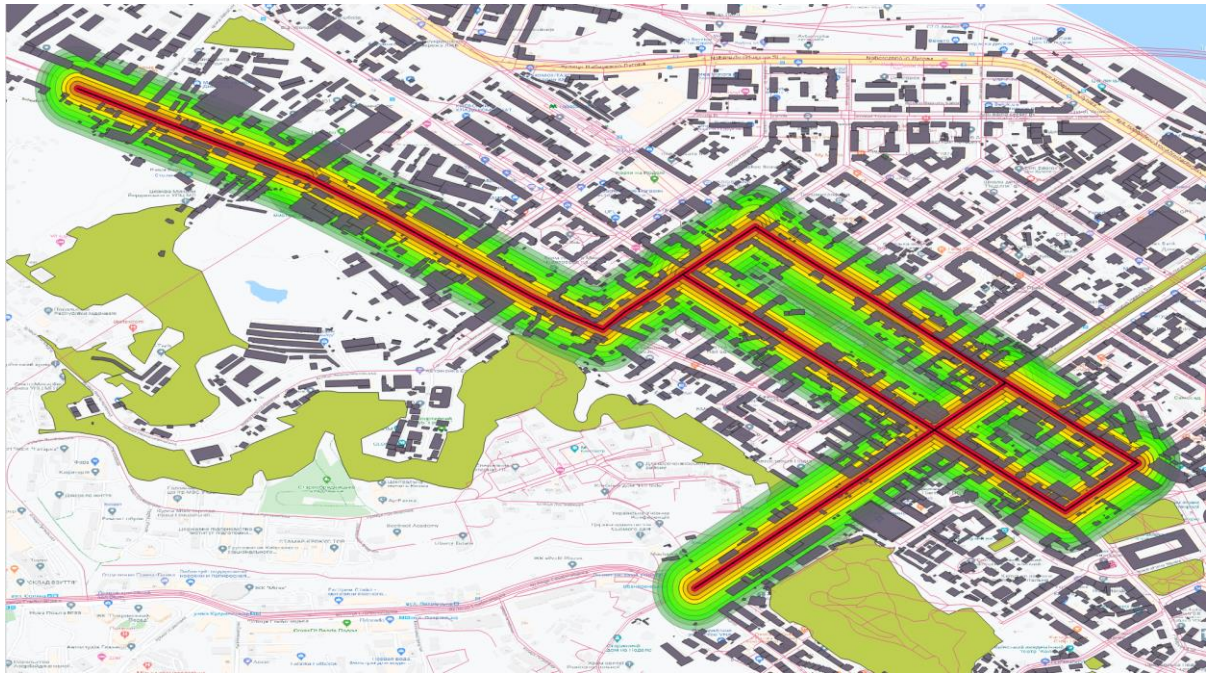
Рис. 3.1.12. Буферна зона шумового забруднення вулиць
