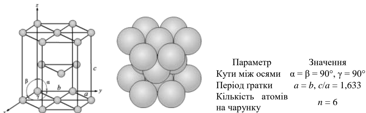
Рис. 1.11. Ґратка гексагональна щільного пакування
