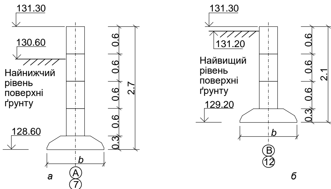
Рис. 12. Глибина закладання фундаментів у безпідвальній частині будівлі: а – для найбільшого заглиблення; б – для найменшого заглиблення
