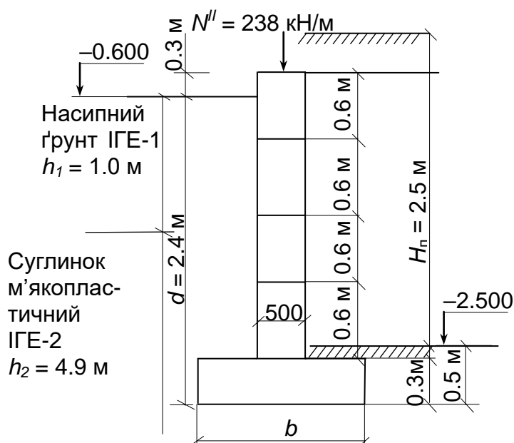
Рис. 25. Розрахункова схема для комбінованого гнучкого стрічкового фундаменту
