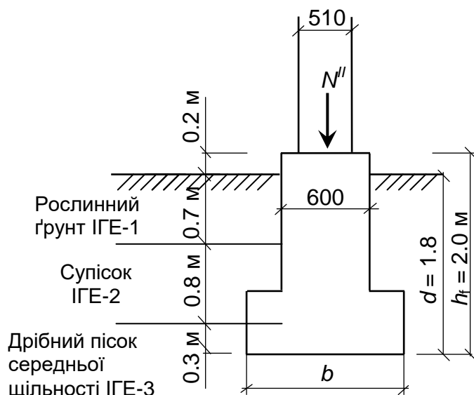
Рис. 22. Розрахункова схема жорсткого стрічкового фундаменту
