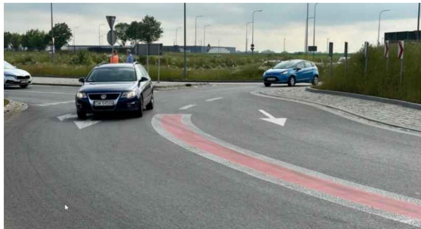
Приклад фарбованих розділювальних знаків на кільцевій дорозі в Польщі (Джерело: FHWA)
