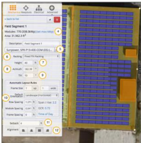
Рисунок 3. Модель розміщення панелей з параметрами “Field Segment”
