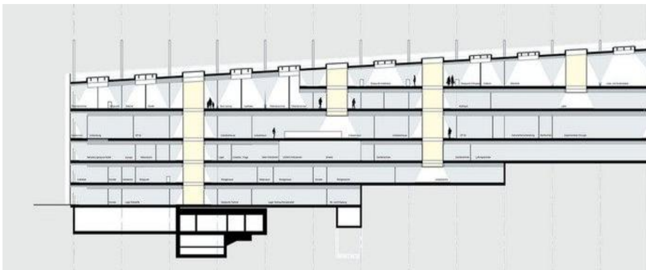
Рис. 2.17. Поперечний переріз первинної системи ІНО, що показує, як можна вставити світлові шахти, щоб ввести природне освітлення вглиб будівлі ІНО Заклад інтенсивної терапії [42].
