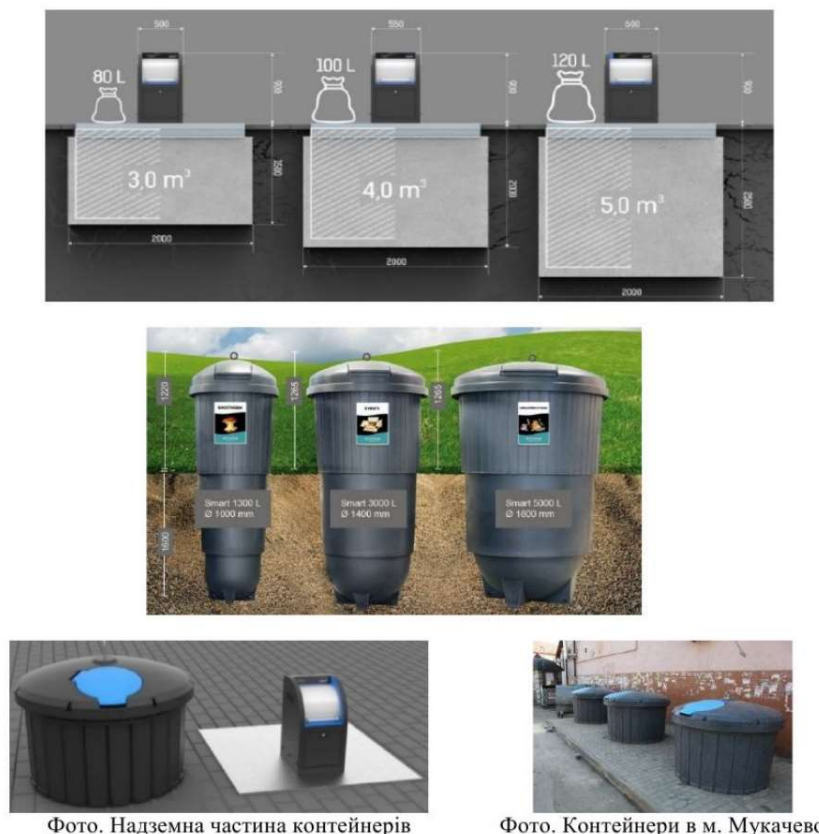
Рисунок 3.2 - Розміри та місткість підземних контейнерів для сміття
