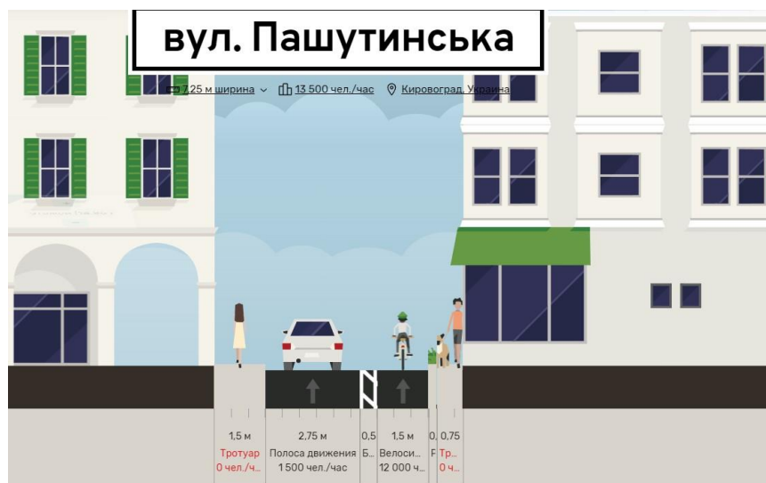
Рис. 3.3 – Проектний поперечний переріз вул. Пашутинська
