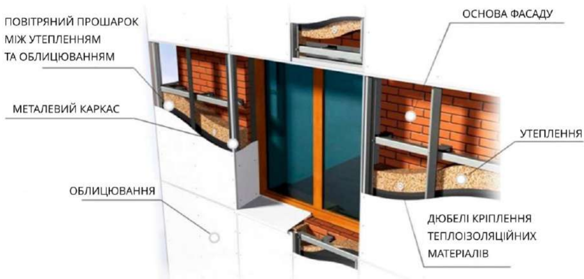
Рис 6.5. Схема вентильованого фасаду
