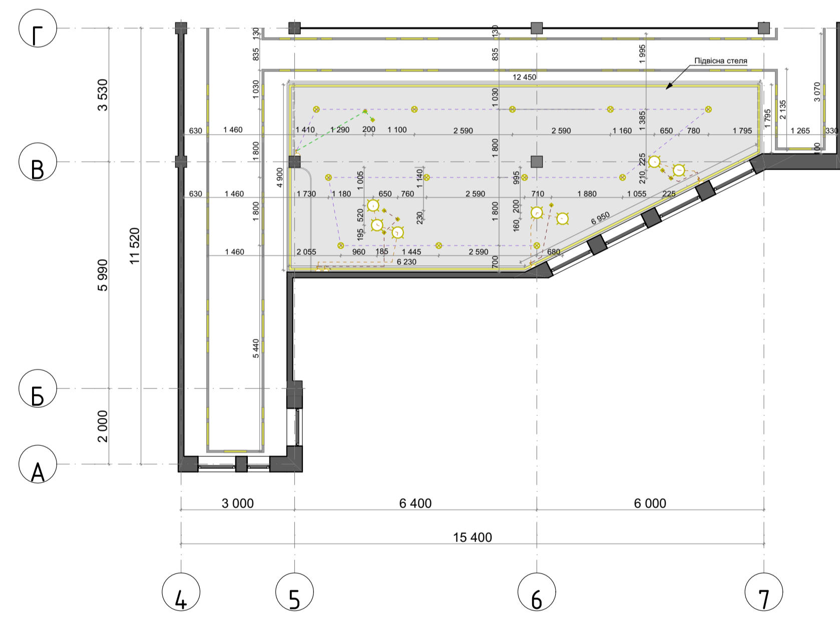
ПЛАН СТЕЛІ ТА РОЗМІЩЕННЯ СВІТИЛЬНИКІВ М1:100
