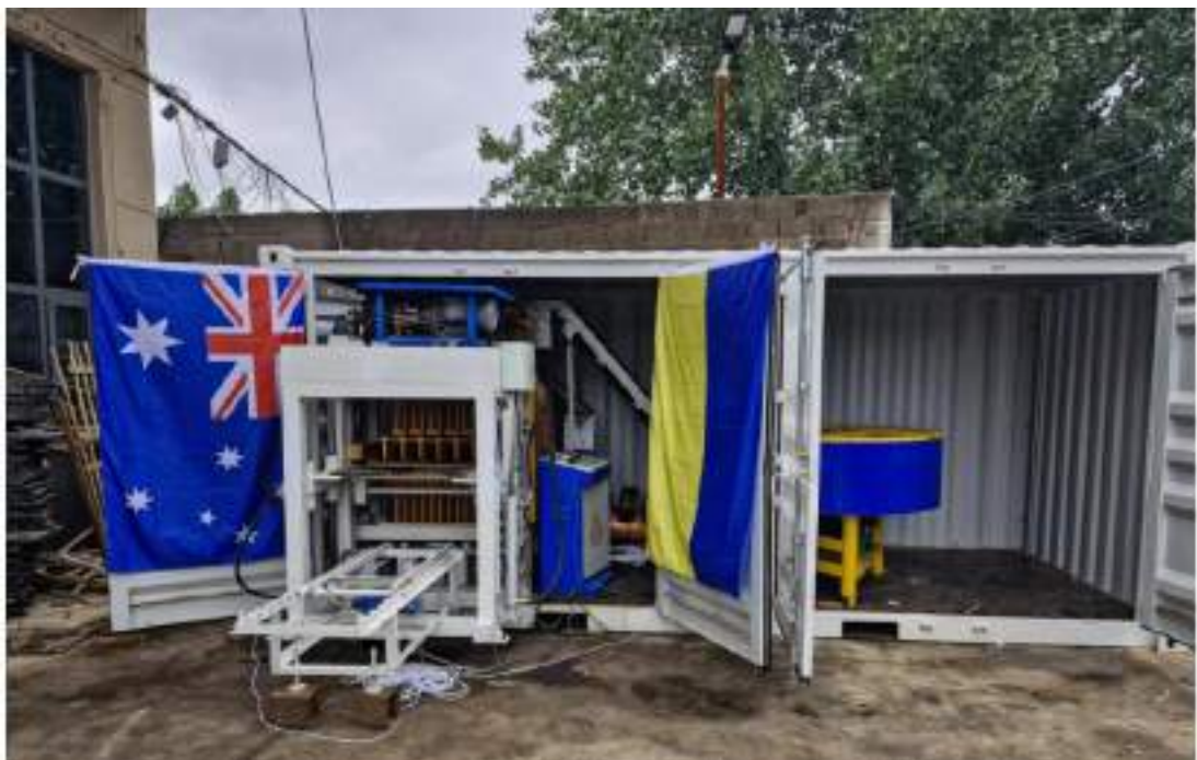
Рис.1.3 Мінізавод із переробки відходів від руйнування. Фото: Mobile Crisis Construction [38].
