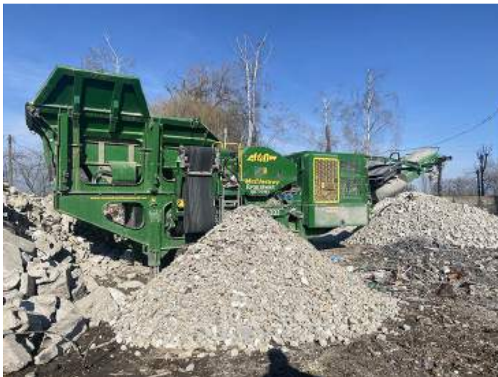
Рис.1.6 Мобільна дробильна установка для рециклінгу будівельних відходів та отримання вторинного щебеню [41].
