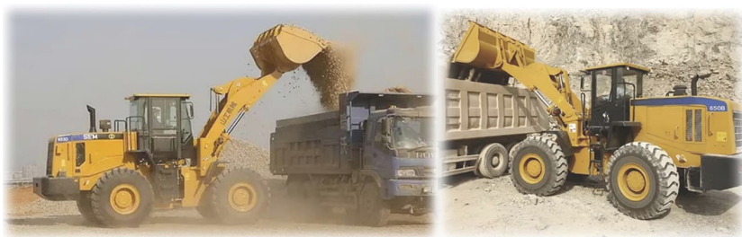
Рис. 2.41. Розвантаження ковша навантажувача в транспортний засіб
