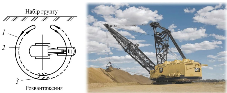
Рис. 2.36. Робота драглайна човниково-кільцевим способом:
