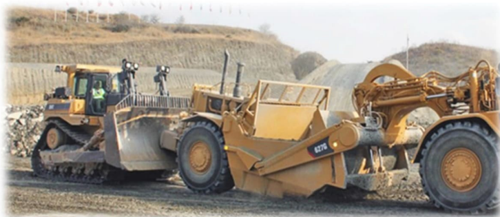
Рис. 2.18. Використання бульдозера для штовхання скрепера
