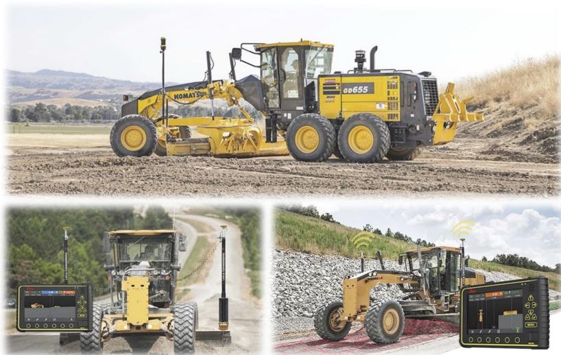
Рис. 6.5. Приклад візуалізації роботи грейдера з GPS-навігацією
