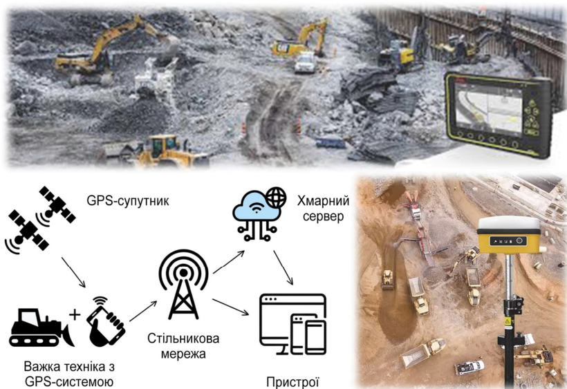
Рис. 6.3. Принцип роботи GPS-системи моніторингу будівельних машин
