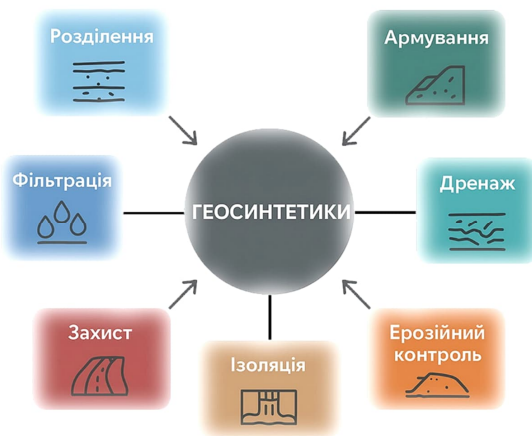
Рис. 6.2. Функціональні можливості геосинтетичних матеріалів
