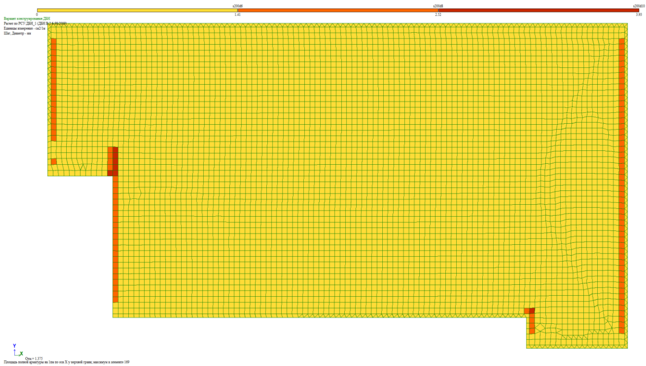
Рис. 3.11 Підбір верхньої арматури по осі X (макс. Ø10)
