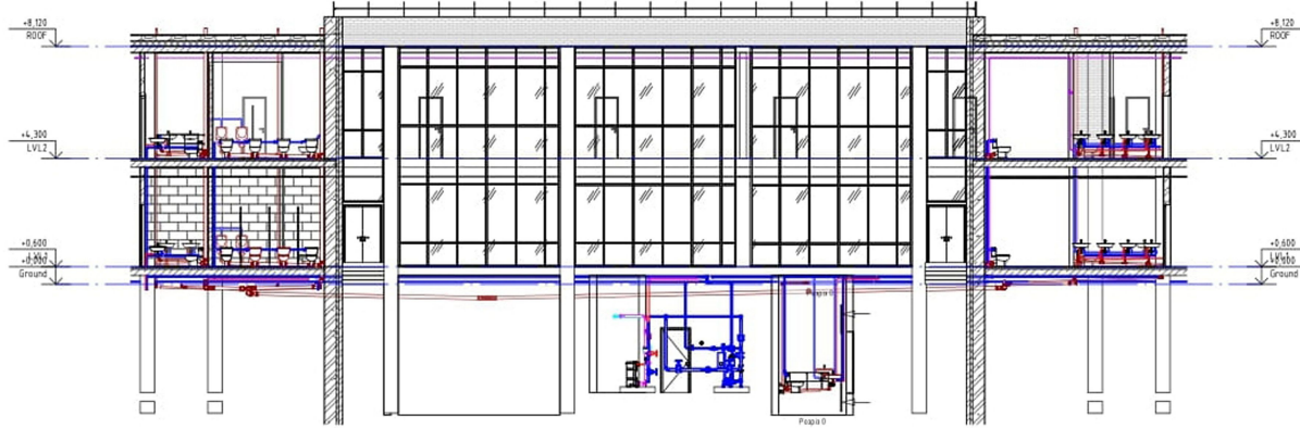
Аксометрія системи водопостачання М1:100
