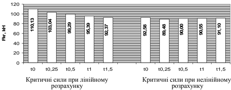
Рис. 7. Результати розрахунків центрально стиснутого стержня
