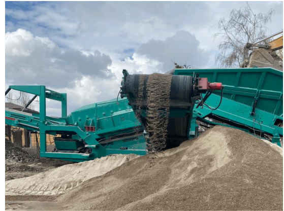
Рисунок 4. Процес утилізації будівельного сміття [3]
