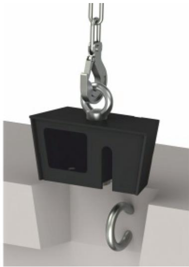
Рис. 2.21. Схема вилучення петле утворювача за допомогою крану
