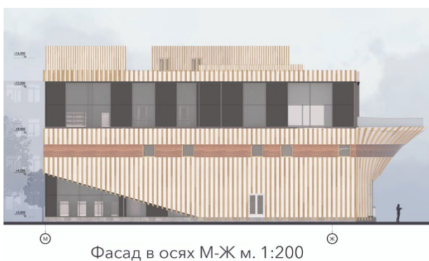
Рис. 10.10. Фасад в осях М-Ж
