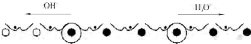
Рисунок 4.7 – Схематический перенос гидроксила ( \text{OH}^- ) и гидроксония ( \text{H}_3\text{O}^+ ) в структуре молекул воды
