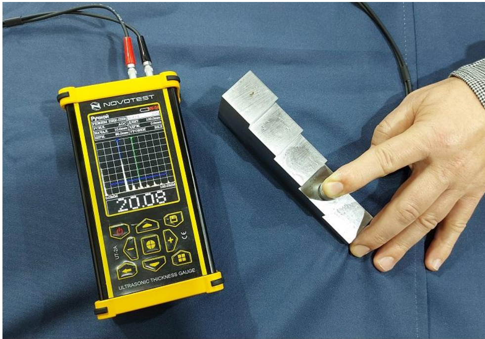
Фото 4.5. Ультразвуковий дефектоскоп NOVOTEST LS2590
