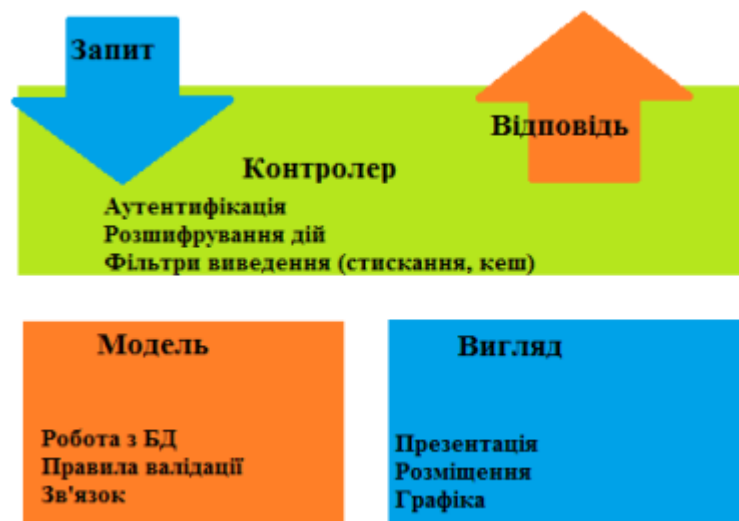
Рисунок 2.2. Шаблон проектування MVC - Model View Controller
