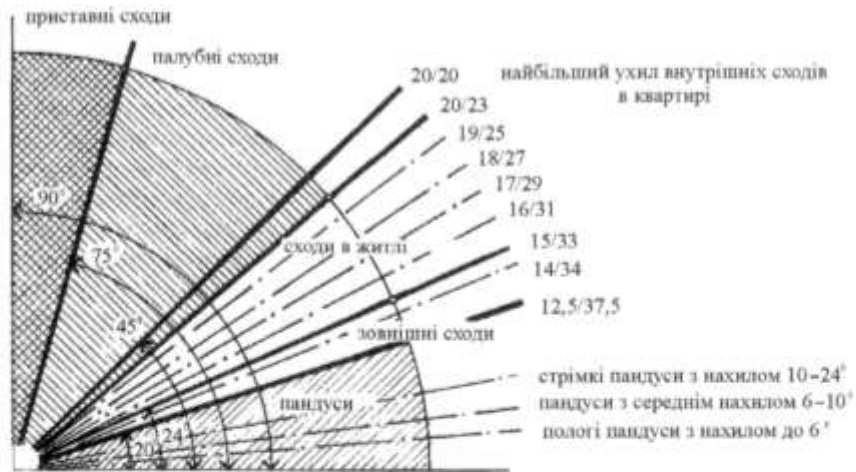
Ухил для пандусів, зовнішніх сходів, внутрішніх сходів, робочих та палубних сходів
