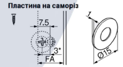
FA Накладення фасаду Пластина зміщується на 3 мм
