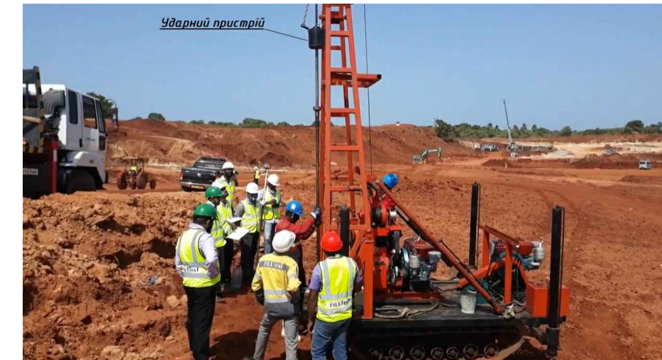
Проведення динамічного випробування ґрунту на будівельному майданчику (Dynamic Cone Penetration Test)
