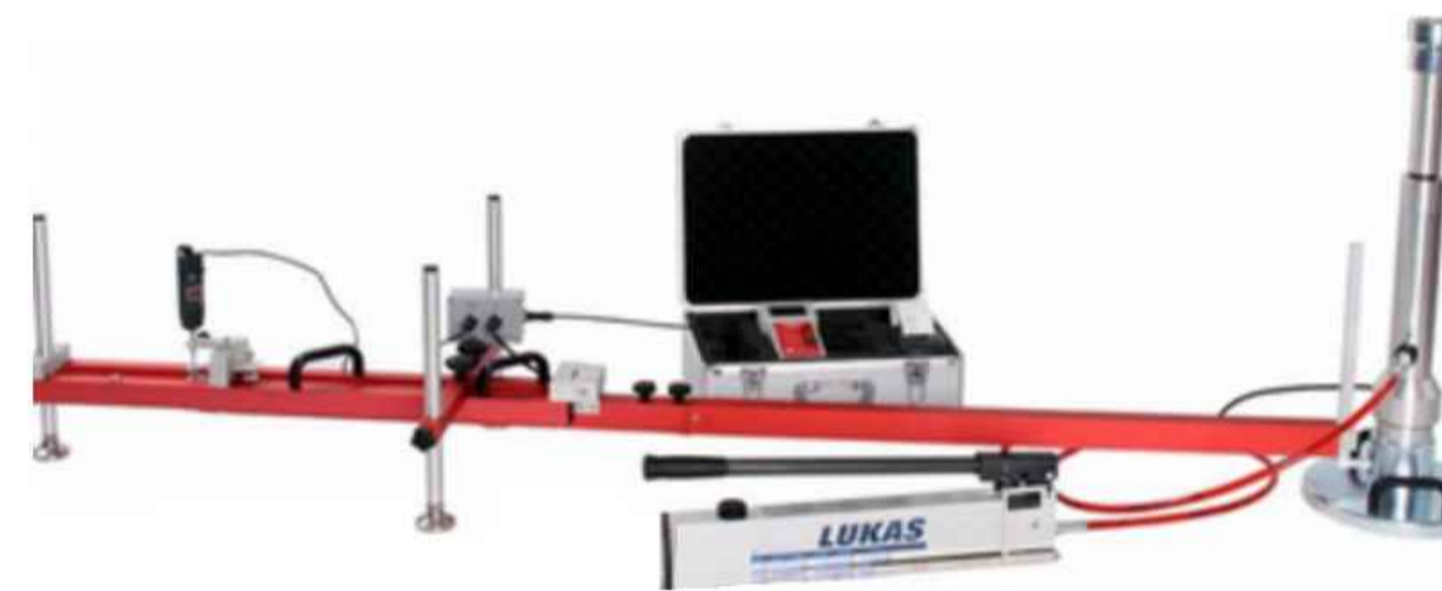
Штампова установка статичного гавантаження "HMP PDG" від компанії «HMP Magdeburger Prufgeratebau GmbH»
