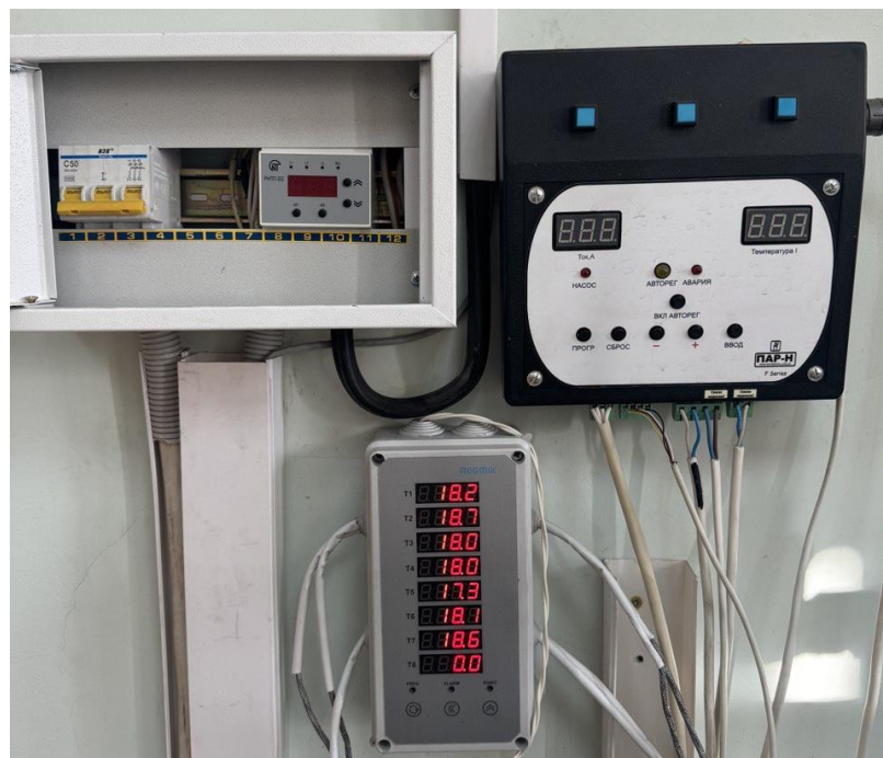
Рис. 2.1. Загальний вигляд органів керування стенду (верхній ряд зліва – направо: ввідний автомат, пульт керування, нижній ряд – цифровий перетворювач для збору температурних даних)
