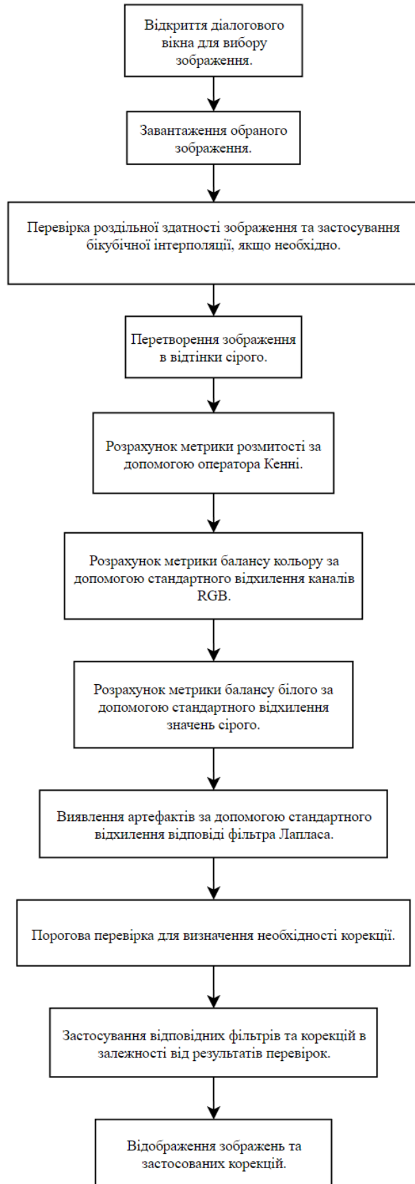
Рисунок 3.2 – Логічна схема програмного продукту
