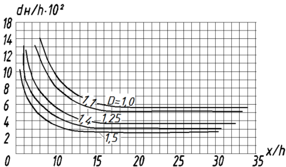
Рис. 8. Графік визначення крупності каменю для влаштування гнучкої рисберми
