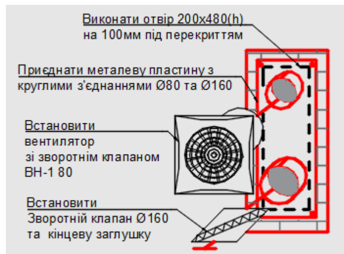
Рис. 5.5. Вузол «Б»- підключення кухонного вентилятора та кухонної витяжки «зонта»
