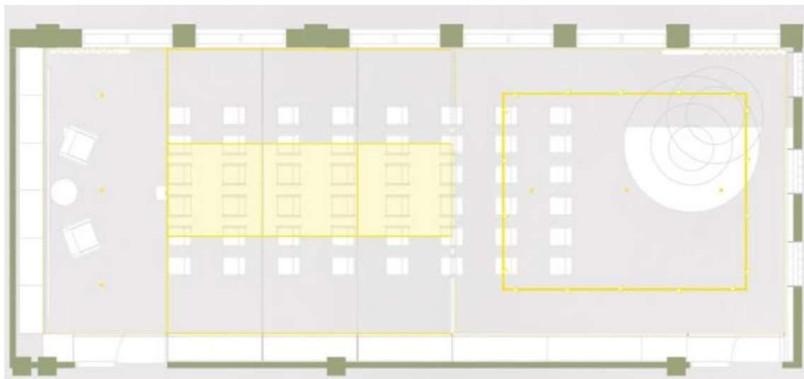
Рис.5.1.3 План стелі приміщення з розташуванням освітлювальних приладів
