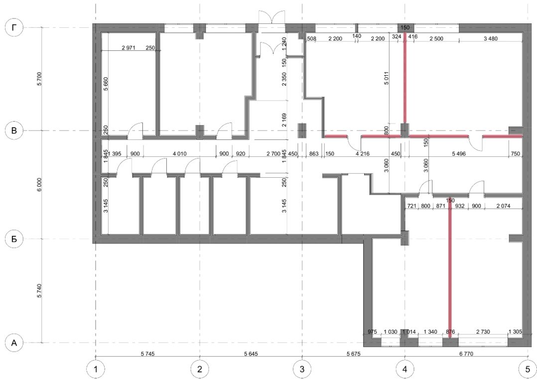
Рис.2.3.1 План демонтажу перегородок
