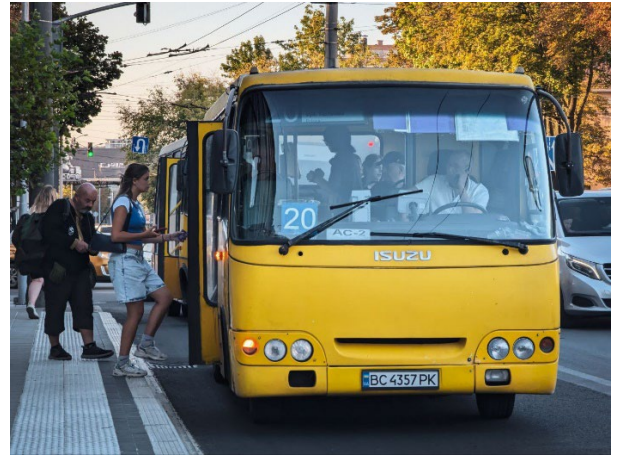
Рис. 1.20., 1.21., 1.22., 1.23. Неправильний підїзд громадського транспорту після встановлення касельського бордюру у м.Львів.
