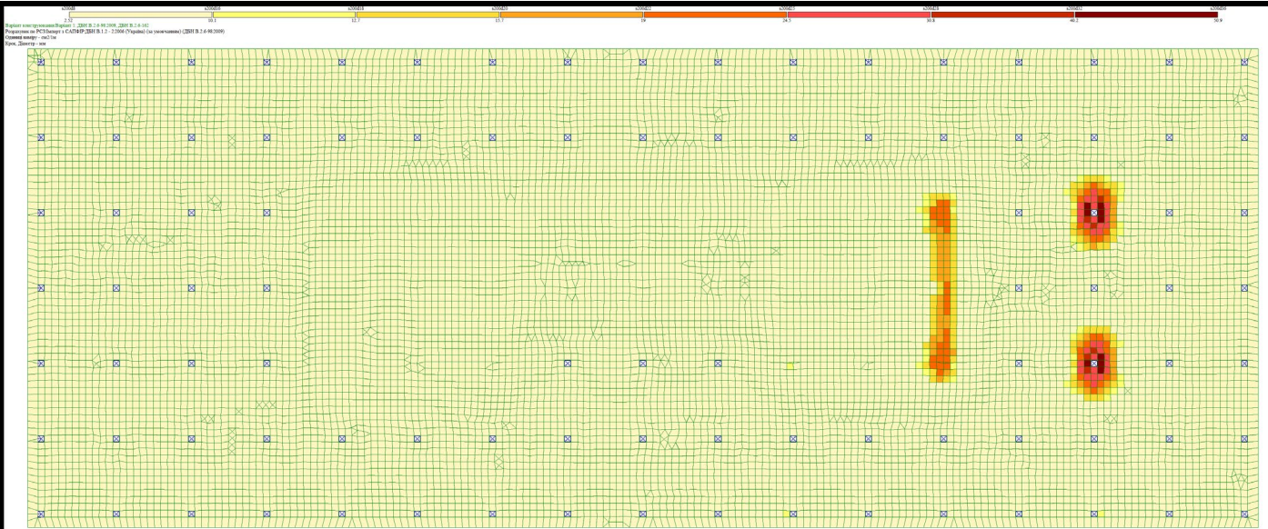
Рис.3. Мозаїка армування плитного фундаменту нижньої зони по осі У
