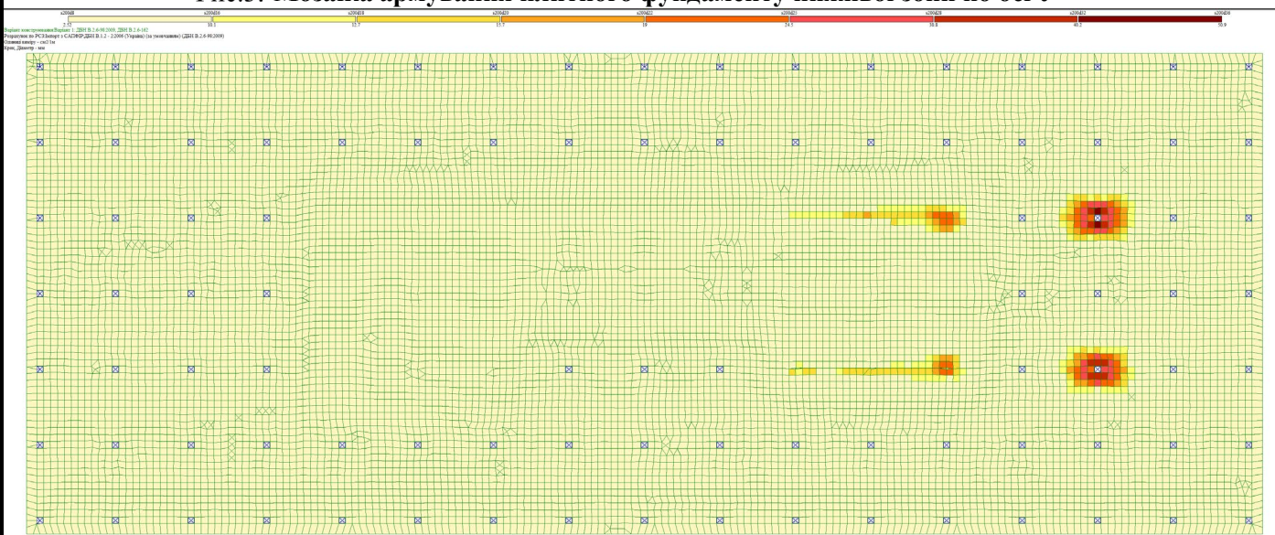
Рис.3. Мозаїка армування плитного фундаменту нижньої зони по осі У
