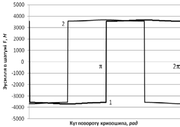
Рис. 5. Графік зміни зусилля в шатунах F_1 (1) та F_2 (2) в залежності від кута повороту кривошипів.
