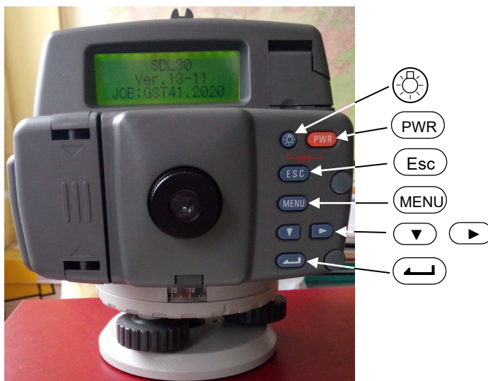
Рис. 3.3. Клавіатура нівеліра SDL30
