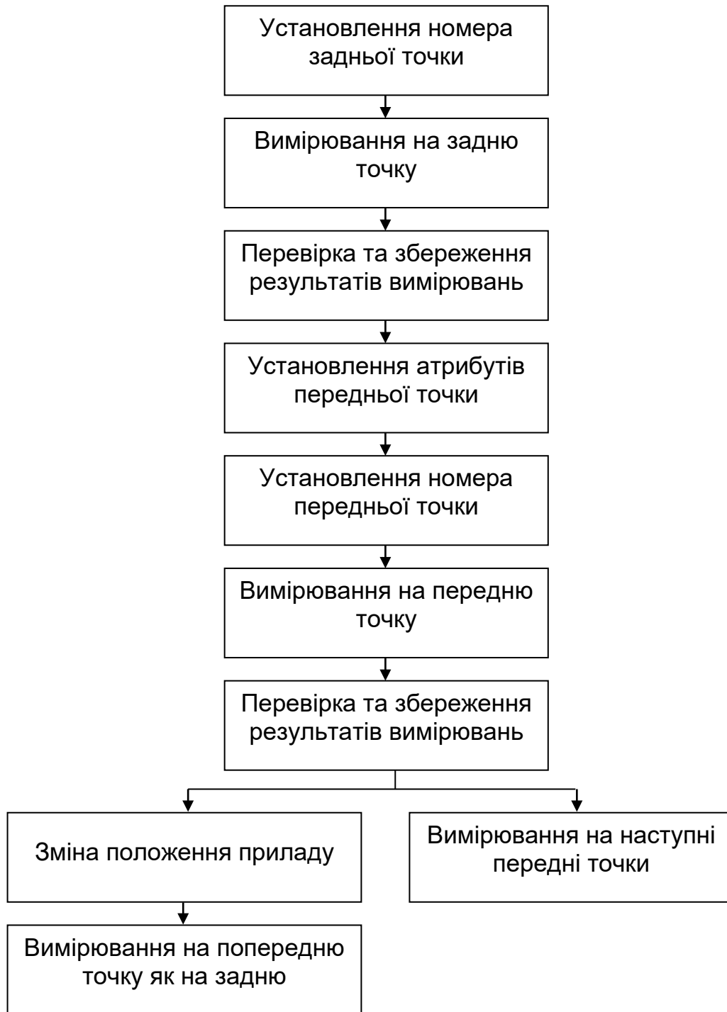
Рис. 6.3. Загальний порядок вимірювань на станції нівеліром SDL30
