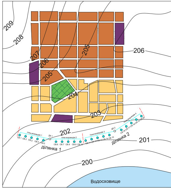
Схема до розрахунку гілок 1 і 2 сифонного водоводу при подачі у збірний колодязь ДК1 дренажних вод
