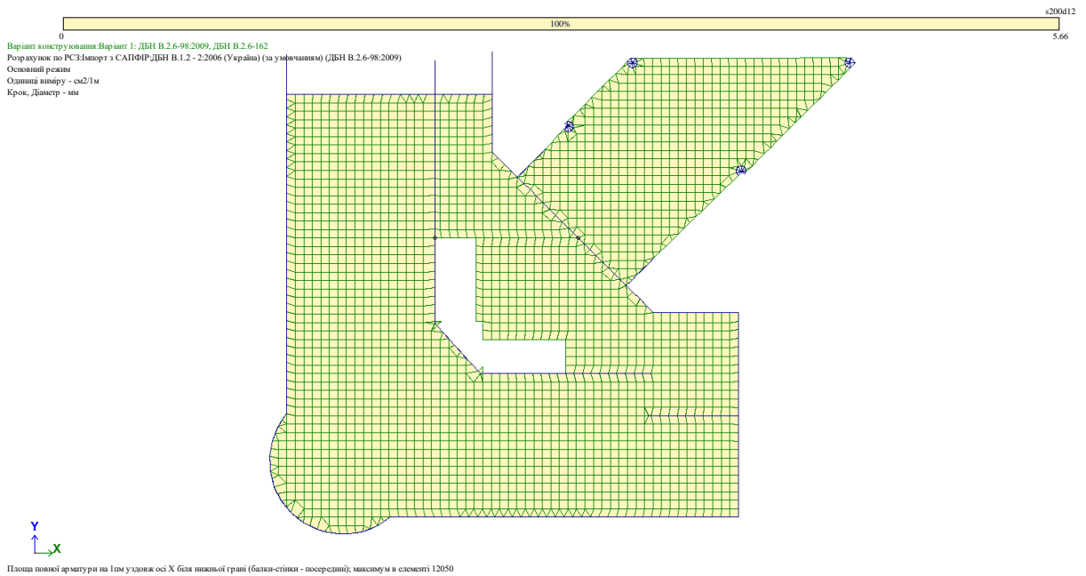
Рис. 2.28 Площа повної арматури на 1м уздовж осі X біля нижньої грані (балки-стілки - посередині) для плити перекриття 1-го поверху
