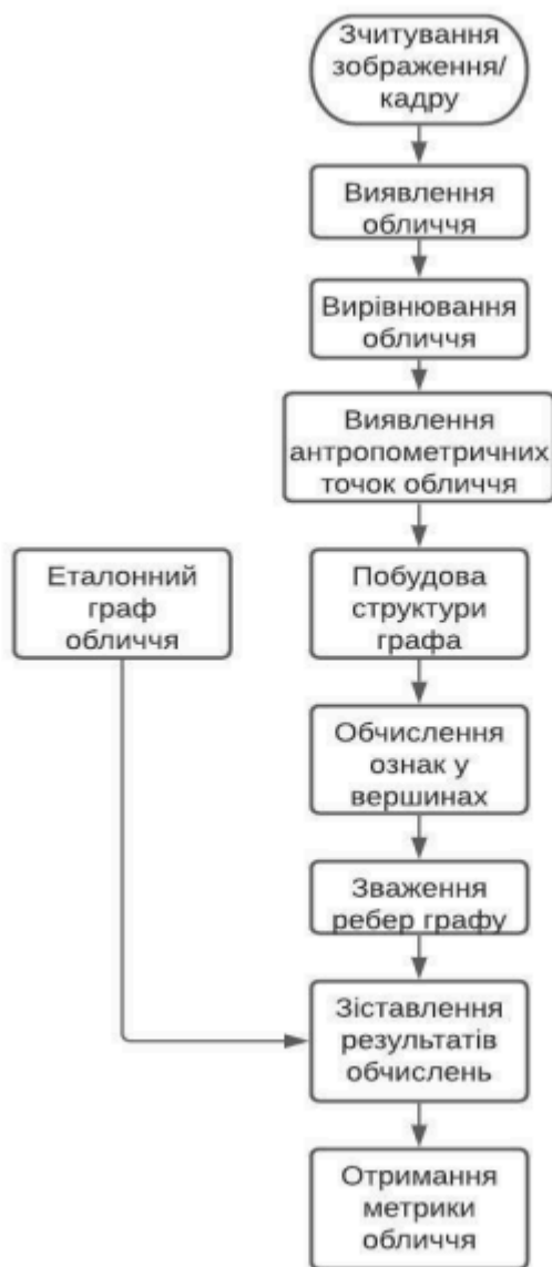
Рис. 1.4 Алгоритм методу гнучкого порівняння на графах
