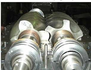
Рисунок 8.1 – Зачеплення гвинтів паро-гвинтової турбіни
