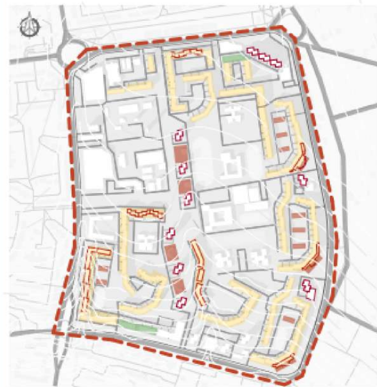
Схема реконструкції забудови М 1:5000 Умовні позначення: доцільні нові будівлі, які будуть зведені за умов реконструкції фактичний стан забудови доцільні нові будівлі, які будуть зведені за умов реконструкції введення функцій на 1-4 поверхах межі ділянок
