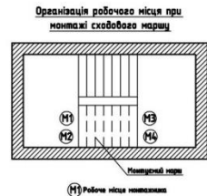
Організація робочого місця монтажників (на перекритті) при монтажі проміжної сківи
