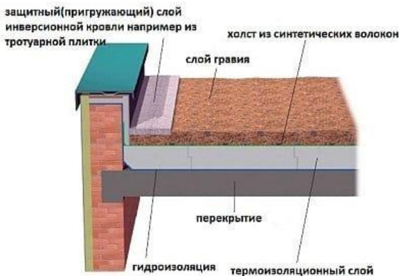
Рис. 6.4. Конструктивний розріз покрівлі [16].
