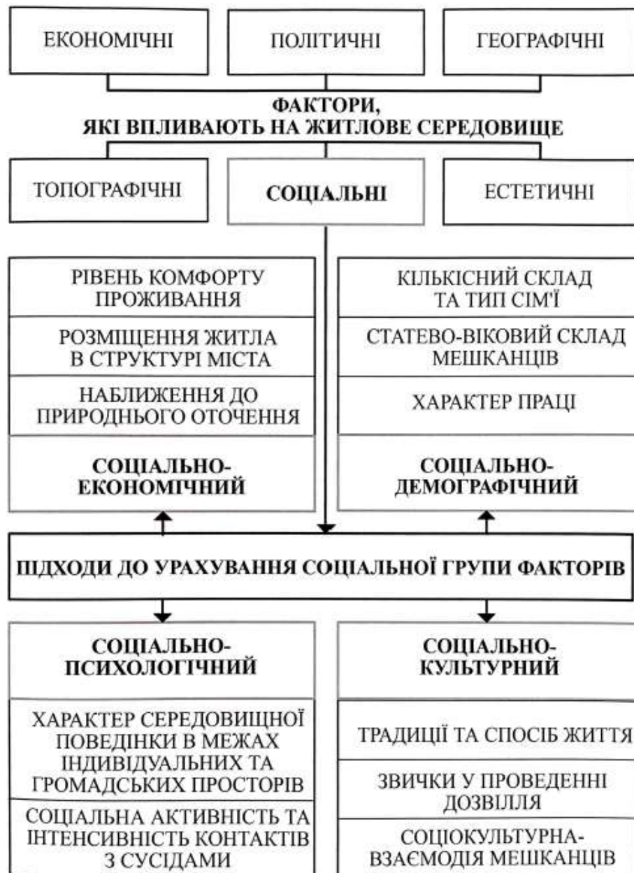
Рис. 1.1.10. Методичні підходи до урахування групи соціальних факторів у проектуванні житлових утворень (за О. Костюк) [9]
