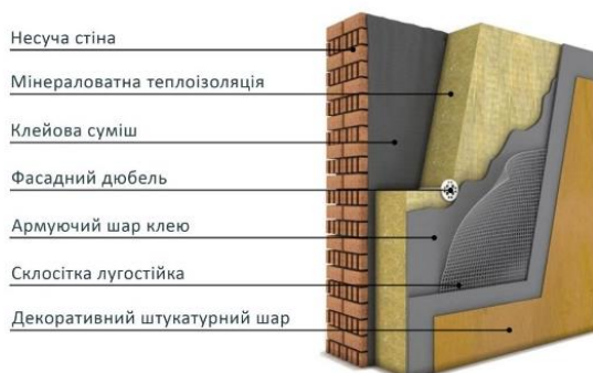
Рис. 16.1. Варіант схеми утеплення зовнішньої стіни мінераловатною плитою
