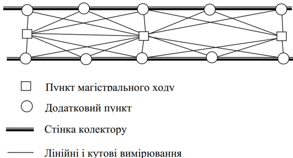
Рис. 3.11 Схема планової опорної геодезичної мережі у колекторі на прямолінійних ділянках
