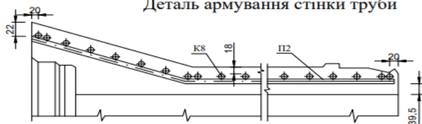
Деталь армування стінки труби
