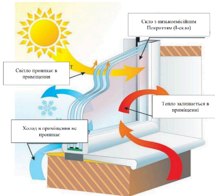
Рисунок 2.5 – Принцип роботи селективного скла
