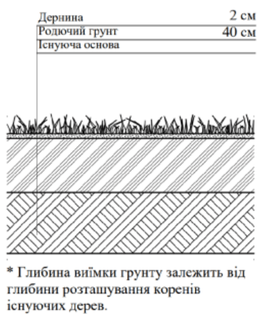
Рис.3.4.7. Схема створення газону
