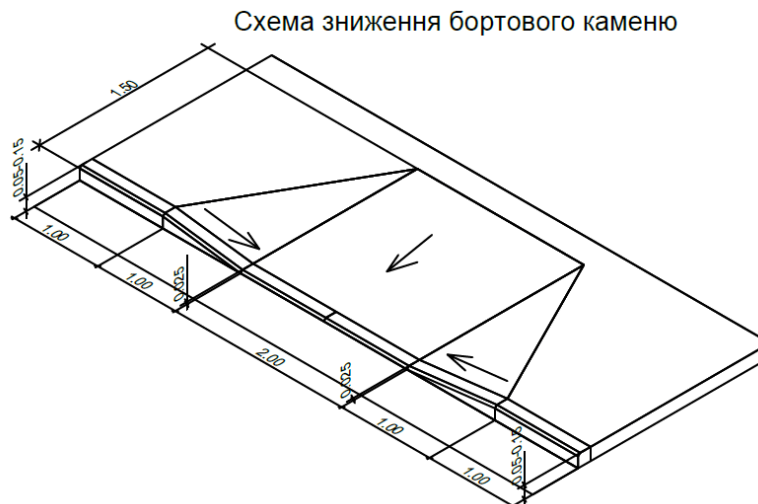
Рис. 3.3.1 Схема заниження бортового каменю
