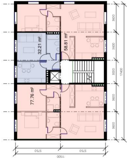
ПЛАН НОВОЇ ТОРЦЕВОЇ СЕКЦІЇ (М 1:200)
