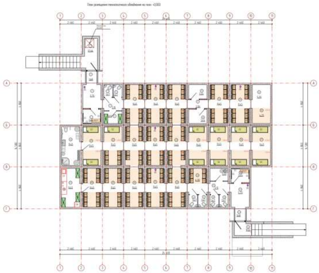
Рис. 5.3.3.1. Приклад укриття на 250м 2 [118]
